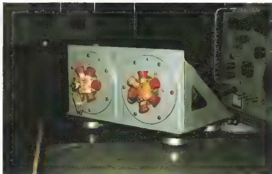
'Opsporing verzocht': de antenne-schakelunit met N-connectoren.
